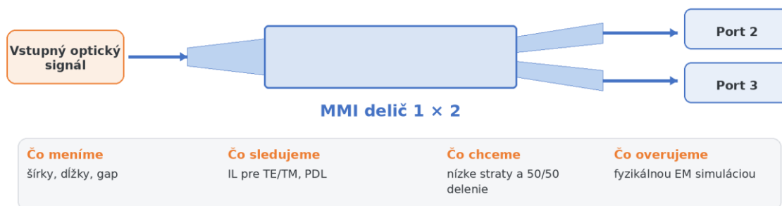
Obr. 1. Príklad fotonického prvku riešeného v projekte: 1 \times 2 MMI delič a parametre, ktoré ovplyvňujú jeho optickú odozvu.
