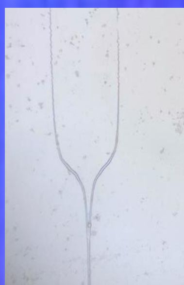
CLSM snímka \text{Ga}_2\text{O}_3 deliča výkonu (Y-branch)
