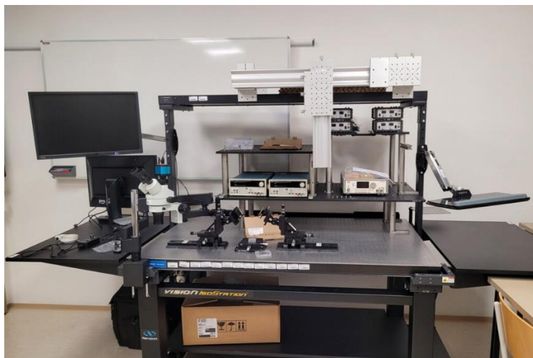
Obr. 2 Experimentálne pracovisko na presné polohovanie optického vlákna a charakterizáciu väzby svetla medzi optickým vláknom a fotonickým integrovaným čipom.
