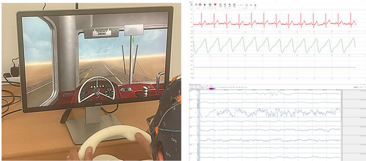
Obr. 1. Namerané údaje z prototypu inteligentného volantu (hore) a z biosilňovača g.Hlamp (dole)
