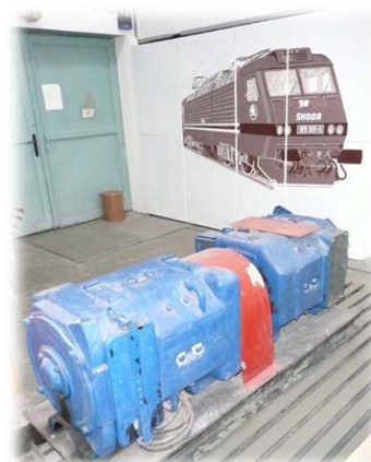
Laboratórium aktivity 2.2 – sústrojenstvo trakčných motorov
